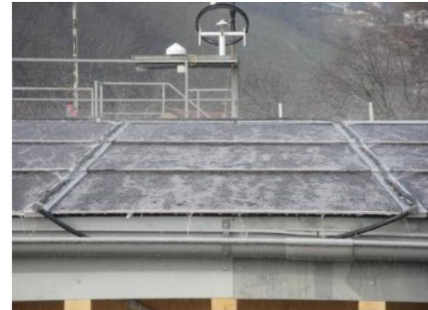
Mechanische Prüfungen und Wasserdichtigkeitstest am der **Swiss PV Module Test Centre-SUPSI**
